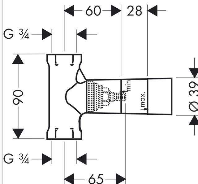
Grundkörper 130 l/min für Abstellventil Unterputz Spindel, DN20
