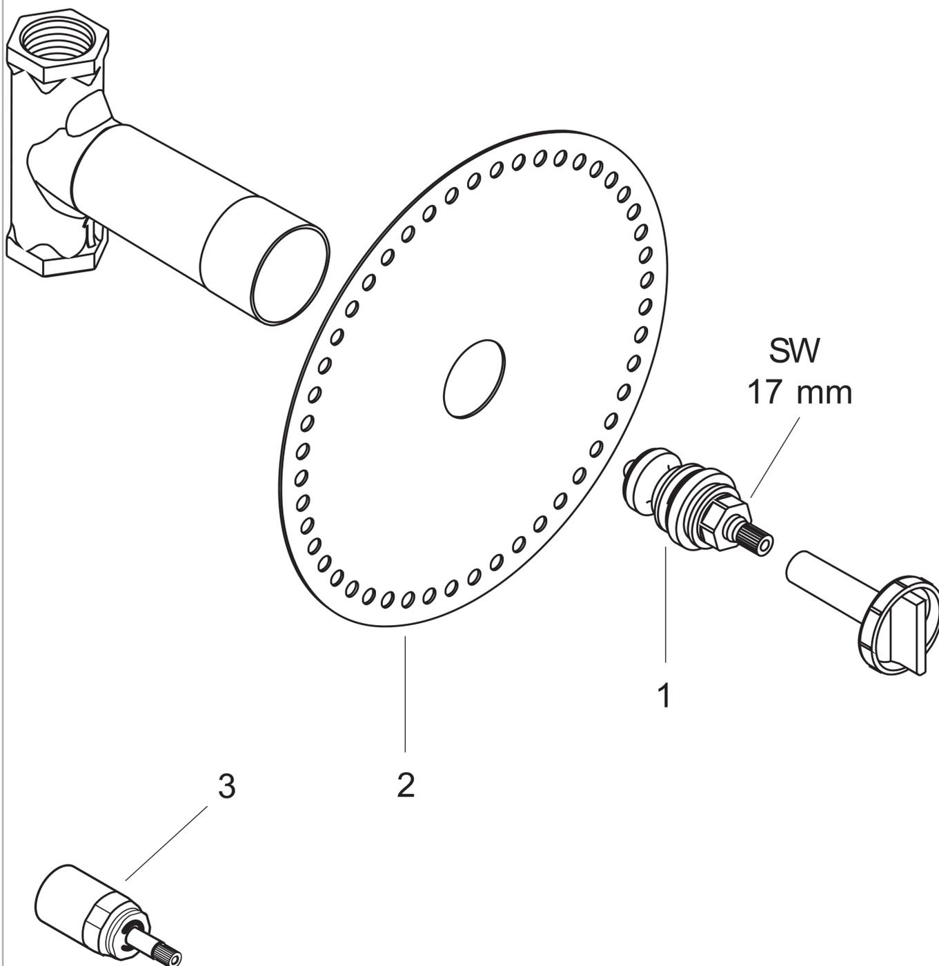
**Grundkörper 130 l/min für Abstellventil Unterputz Spindel, DN20**
